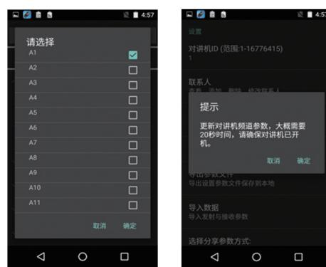
点击“对讲机写频”按钮，把通过APP设置的所有参数一次性写入对讲机芯片里；以后可通过旋转信道旋钮切换频道。
