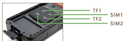
打开卡槽盖，按照卡槽盖表示分别装入Micro SIM和TF卡
