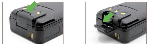
拆卸电池，如图所示方向，打开电池锁扣，便可取下电池；
